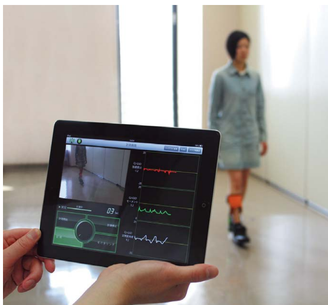
GSD用計測アタッチメント 取付例
