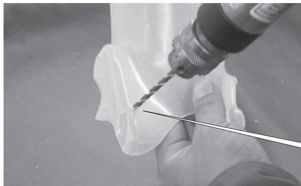
ロッドキャップ用セットスクリュ一部 →  $\phi 4.1\text{mm}$ 穴
