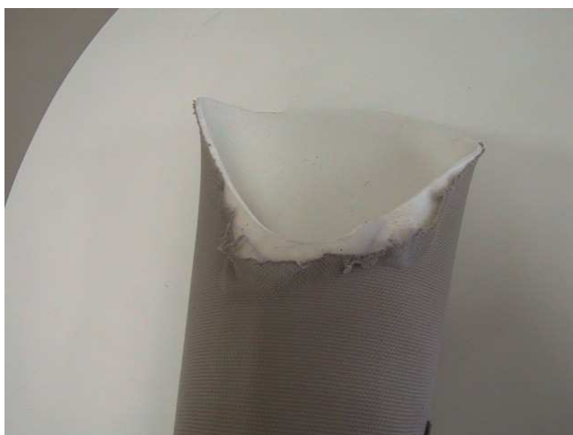
写真9 補強しなかったため生じたトリミングライン付近の剥離 (納品後4カ月) トランスフェモラルライナー ユニカル
