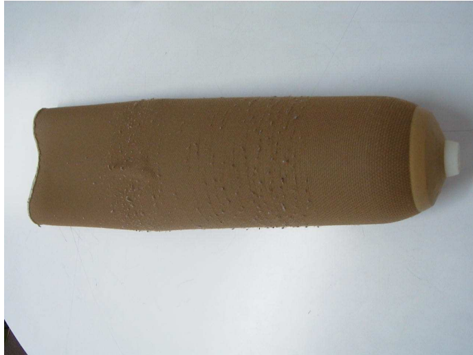
写真 11 ファブリック部に生じた毛玉 (納品後 6 カ月) コンフォートロックライナー
