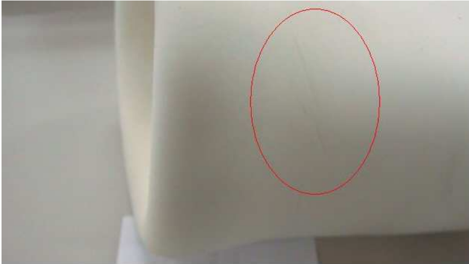
写真4 脛骨遠位端部のヒビ (納品後5カ月) デルモロックライナー6mm厚
