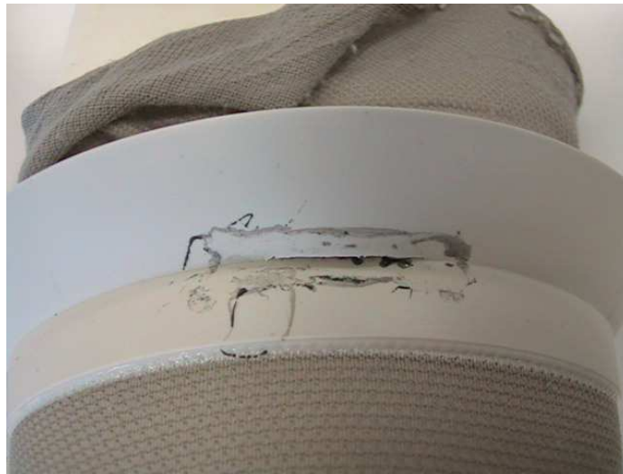
写真 12 HSM 部に生じた裂け目 (納品後 4 カ月) トランスフェモラル シールインライナー
