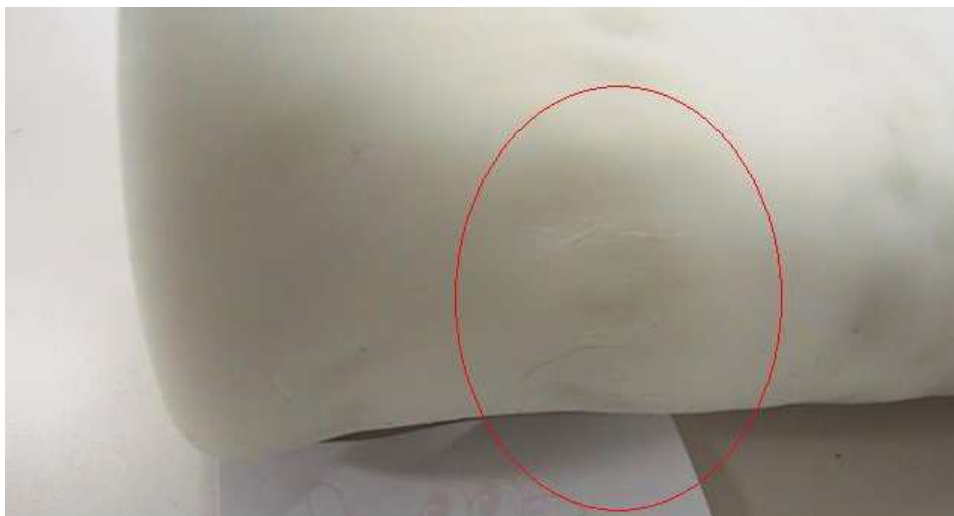
写真5 遠位部に生じたヒビ (納品後3カ月) コンフォートクッションライナー
