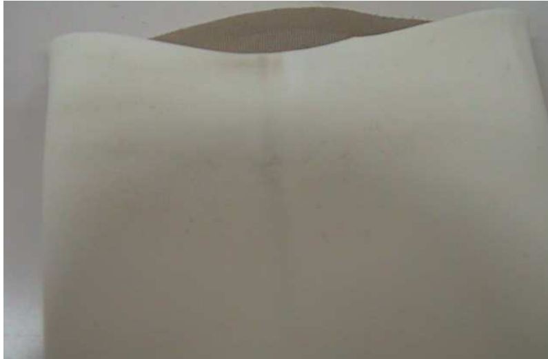
写真 6 シリコン表面に生じた毛羽立ち (納品後 3 カ月) シナジーロックライナー
