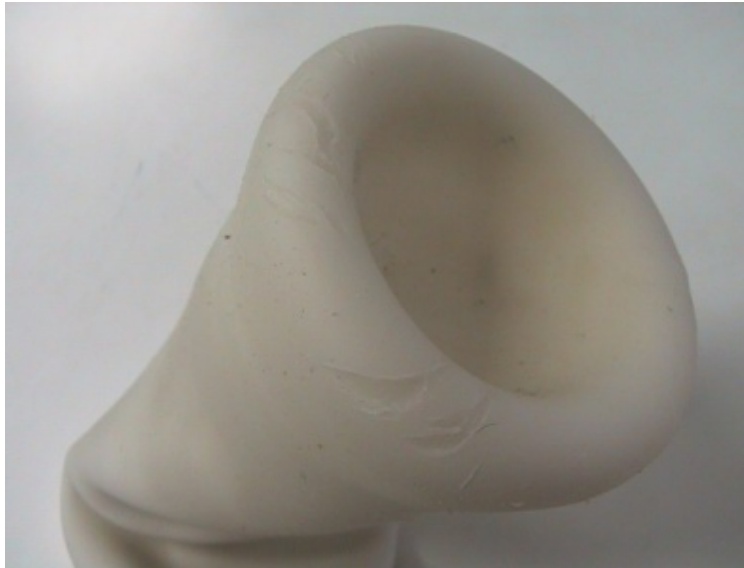
写真1 遠位端より3cm近位の裂け目 (納品後1カ月) デルモロックライナー
