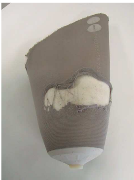
写真10 断端中央部付近に生じた剥離 (納品後4カ月) トランスフェモラルライナー ユニカル
