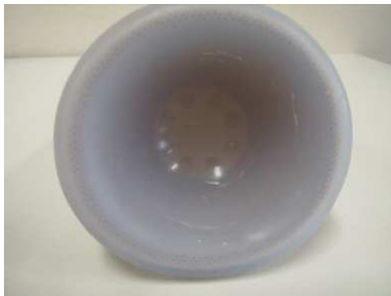
写真2 アンブレラから近位2cmに生じたヒビ (納品後10日) コンフォートロックライナー
