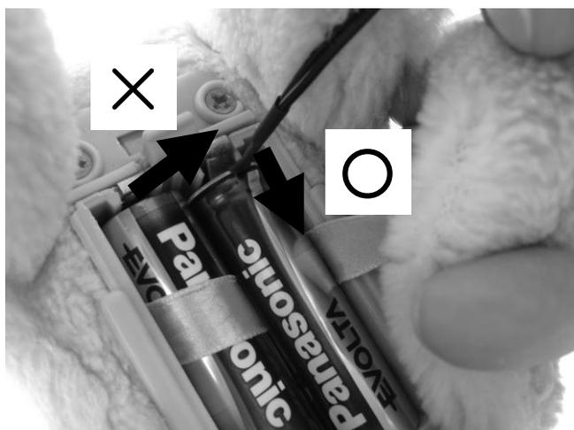
×：水平方向に圧力をかけると根元から切断される。
