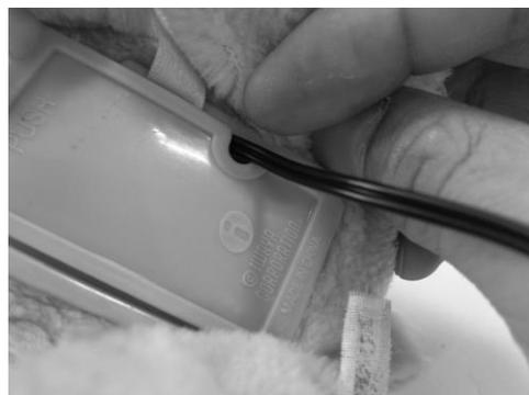
○：穴を開ける事でケーブルに圧力がかからず、断線の防止ができる。
