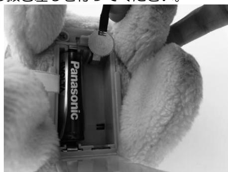
○：電池を外し圧力かけず抜いている。
