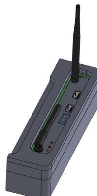
(4) すべての計測が終了した時点で、立てたアンテナを寝かせ、電源スイッチを押します。
