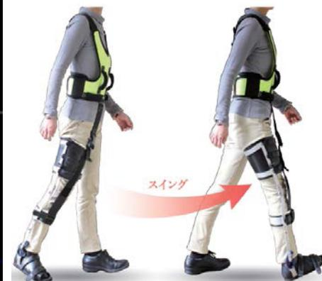
下肢前面のゴムバンドの弾性により股関節屈曲モーメントを補うことで、麻痺側下肢の股関節伸展運動を増大させ、足関節背屈が増大することで蹴り出しをしやすくする。
