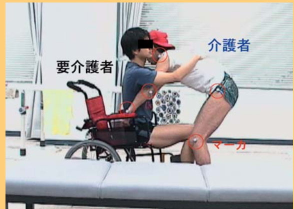
図2 移乗動作の計測風景 車いすから横のベッドへの移乗計測（トランスファー・ボードを使用しない場合）。この計測は、介護者の運動計測であるため介護者のみが床反力計の上に立っている（要介護者は特殊な器具を用い床反力計の上に触れないようにした）。各関節に貼られている銀球がマーカ。
